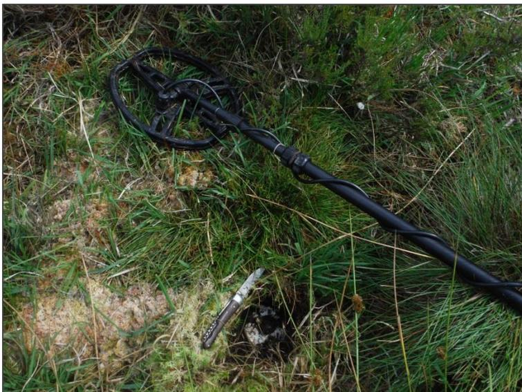
*Détecteur à métaux utilisé en 2015, afin de retrouver les bornes métalliques enterrées entre 1998 et 2000 pour marquer les placettes de suivi de végétation.*
